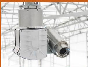
La résolution d'images thermiques du système de caméras infrarouges est de 384 x 288 pixels ou 640 x 480 pixels. L'affichage se fait jusqu'à 50 images/min.
