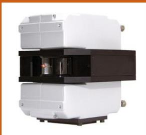
Le scanner infrarouge mesure des températures comprises entre 100 et 650 °C en balayant toute la longueur du four.
